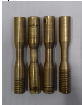
Gambar 5. Bentuk spesimen uji fatigue
